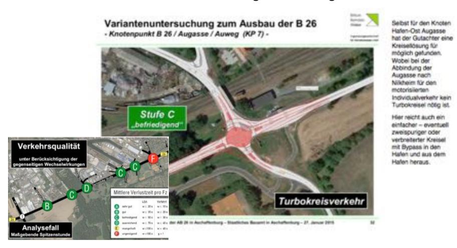
Bei der vorgelegten Kreisverkehrslösung Hafen-West wurde allerdings nicht die Lösung mit einer Extra-Abbiegespur aus dem Hafen als Bypass eingebaut wie es bei der ampelgesteuerten Lösung gezeichnet und berechnet wurde.
